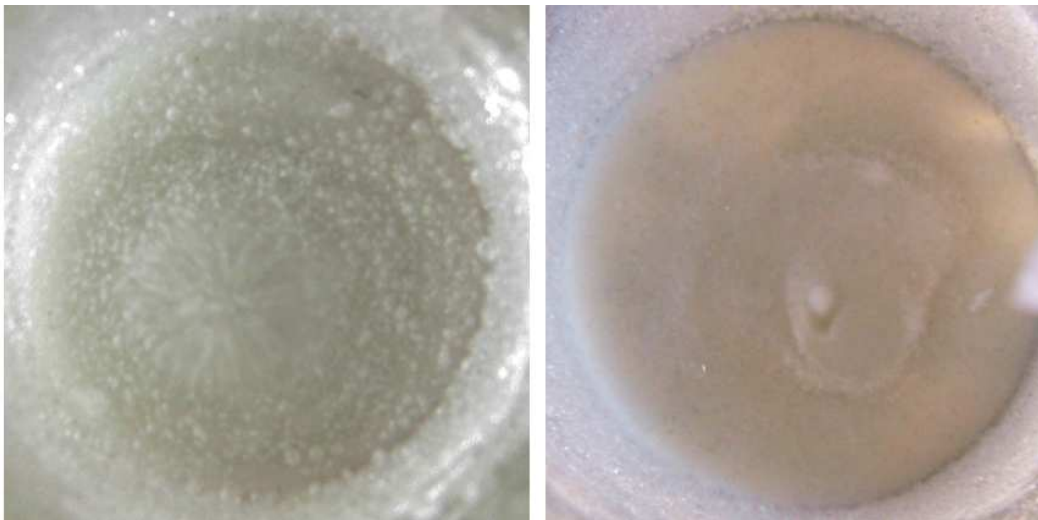
Figure 3.5 : Vue du haut. Le diamètre des dômes est toujours égal à 32 grains, indépendamment de la taille des billes.
