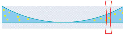
FIG. I.9 : Schéma de principe de la cellule de confinement utilisée pour les mesures de diffusion sous confinement. Le trait rouge délimite la zone confocale.
