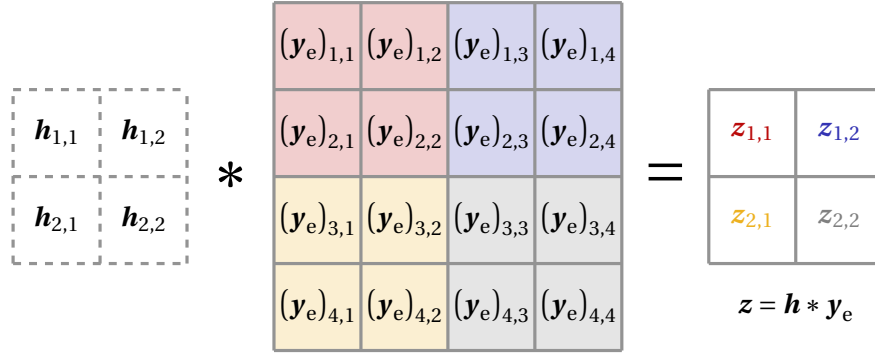
FIGURE 2.17 – Filtrage d'une image de résolution 4 \times 4 par un filtre de taille 2 \times 2 avec un décalage de deux pixels, donc sans recouvrement.
