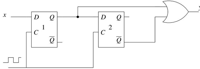
Ce circuit se comporte comme un détecteur de front descendant (avec un not en sortie) : Au départ,  $x = 1$ , et  $\bar{Q} = 0$ , donc  $y$  est à 1. Lorsque  $x$  passe à 0,  $y = 0$ . Mais  $\bar{Q}$  passe à 1 au cycle suivant, et donc  $y$  repasse à 1. Lorsque  $x$  repasse à 1,  $y$  reste à 1.
