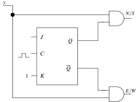
Ici, les deux portes and mettent la valeur des sorties  $N/S$  et  $E/W$  à 0 pendant un cycle. Toutefois, les sorties de la bascule JK continuent de changer de valeur une fois pendant ce cycle. Au cycle suivant, la valeur des sorties  $N/S$  et  $E/W$  est la même qu'avant le passage du piéton.
