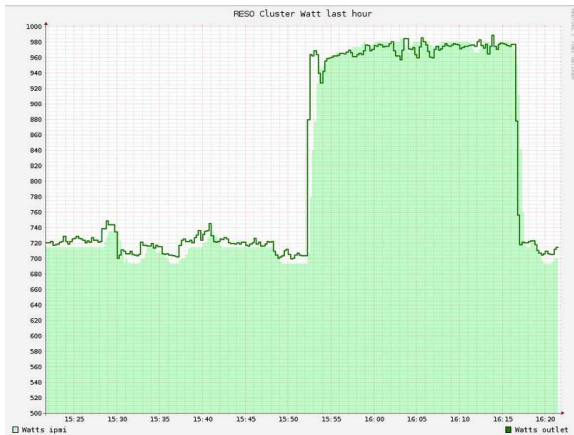
Figure 5.20: Mesures cumulées d'une grappe de machines avec wattmètre omegawatt et IPMI
