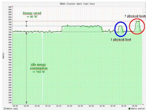
Figure 5.21: Rapport ganglia sur un déploiement de machines virtuelles sur une grappe de machines
