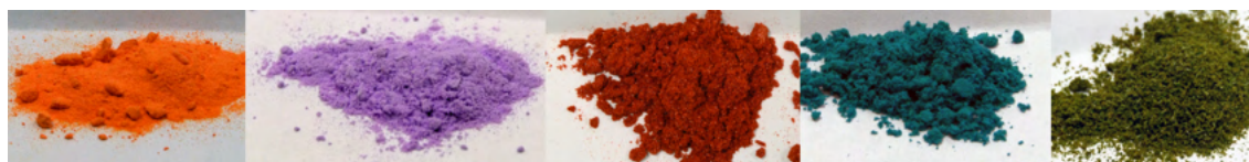
Figure 52 – Quelques complexes de métaux de transition, montrant la dépendance de la couleur de ceux-ci avec le cation métallique ou la nature des ligands associés. De gauche à droite : \text{Ni}(\text{et}_2\text{en})_2\text{I}_2 ; \text{Ni}(\text{eten})_2\text{I}_2 ; \text{Ni}(\text{SCN})_2(\text{PPh}_3)_2 ; \text{Co}(\text{en})_2\text{Cl}_2 ; \text{Co}(\text{en})_3\text{Cl}_3
