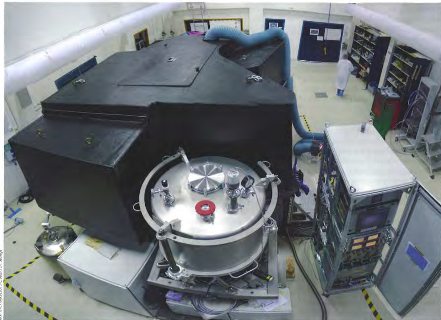
L'IMAGEUR D'EXOPLANÈTES SPHERE (Spectro-Polarimetric High-contrast Exoplanet REsearch) dédié à la recherche systématique ainsi qu'à l'étude d'exoplanètes et installé sur le Très Grand Télescope (VLT) de l'ESO à l'Observatoire du Cerro Paranal dans le désert d'Atacama au Chili. Utilisant l'analyse de Fourier, il permet l'étude des astres dans les longueurs d'onde allant du visible à l'infrarouge.
