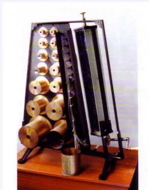
Appareil de Koenig pour l'analyse du timbre des sons. Document Laboratoire de Mécanique et d'Acoustique, CNRS, Marseille.
