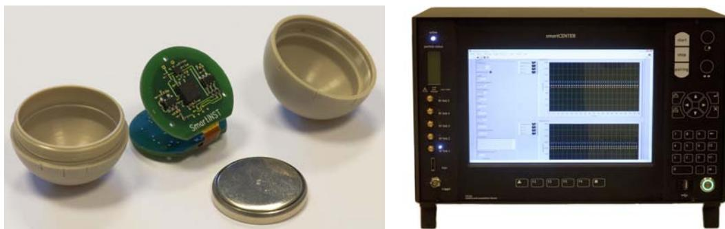
**Fig. II.15:** Gauche : particule instrumentée de diamètre 24mm fabriquée par smartINST qui contient le capteur, une carte d'acquisition et un système d'émission RF. Droite : smartCENTER décodant les signaux émis par la particules.
