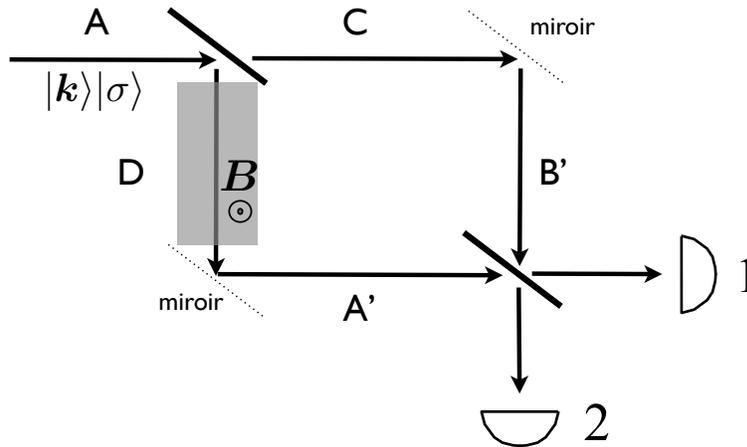
Figure 2: Interféromètre de Mach-Zehnder.
