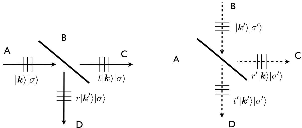
Figure 1: Diviseur de faisceau.
