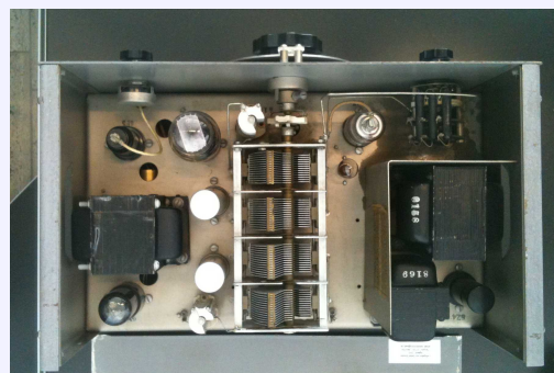
Oscillateur HP200A : à l'intérieur on reconnaît au centre des condensateurs variables, en haut droite une ampoule à filament (dont la résistance augmente avec la température), des ampoules à vide pour l'amplification, un transformateur en bas à droite.
