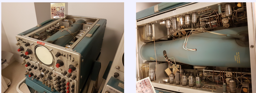
Oscilloscope Tektronix 556 à 50 MHz produit entre 1966 et 1975, dont on voit un certain nombre de triodes sur le dessus.
