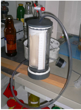
FIGURE 1.5 – Dispositif permettant la détermination d'un débit volumique
