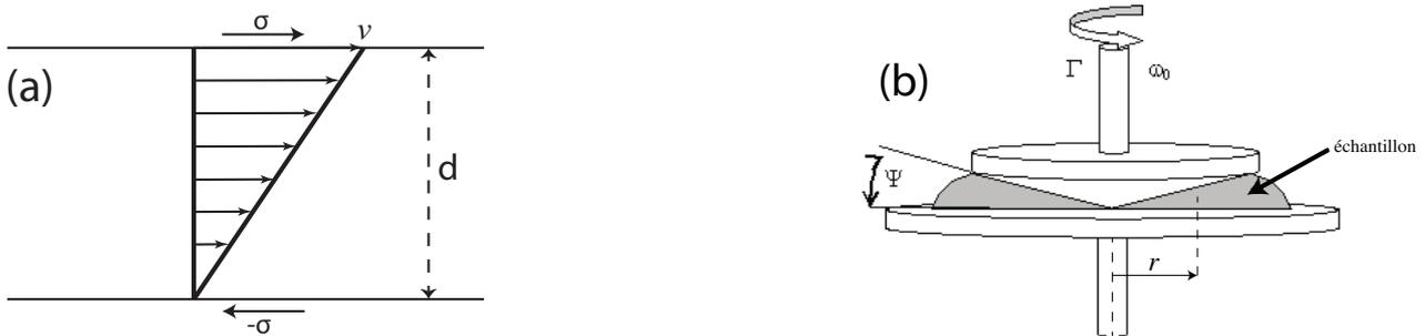
FIGURE 11 – Mesures rhéologiques. (a) Fluide sous cisaillement continu. (b) Rhéomètre cône-plan.
