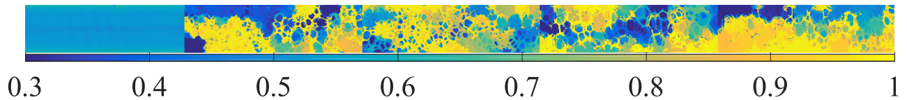
FIGURE 25 – Cartographie de probabilité de passage de liquide en longueur pour Q_G = Q_L = 8 \text{ cm}^3 \cdot \text{min}^{-1} sur 4 barreaux de mousse carbone. Gaz : 0, liquide : 1.
