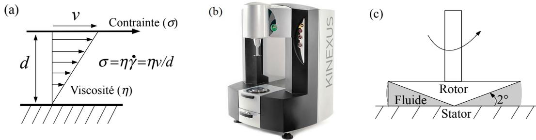
FIGURE I.3 – (a) Définition de la relation entre contrainte  $\sigma$  et viscosité  $\eta$  dans le cas d'un cisaillement simple.  $v$  est la vitesse à laquelle le fluide est cisailé sur une distance  $d$ , et  $\dot{\gamma}$  est le taux de cisaillement  $\dot{\gamma} = v/d$ . (b) Photo de l'un des rhéomètres utilisés (Kinexus, Malvern). (c) Exemple de mesure en géométrie cône-plan.
