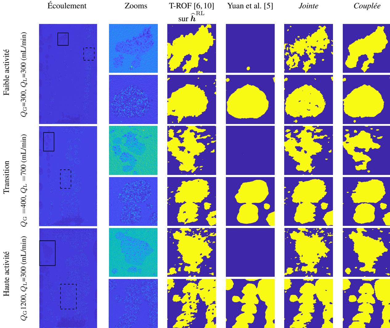
FIGURE 2 – Comparaison des différentes méthodes de segmentation pour plusieurs régimes d'écoulements.
