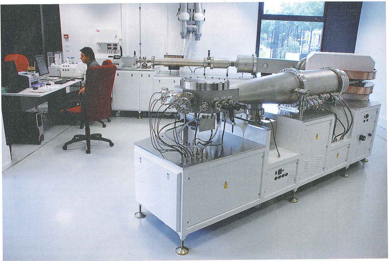
CE SPECTROMÈTRE DE MASSE, installé à l'École normale supérieure de Lyon, est utilisé pour le dosage des éléments radioactifs ou issus de la décomposition de ceux-ci. Les quantités mesurées dans les fossiles permettent de calculer leur âge.
