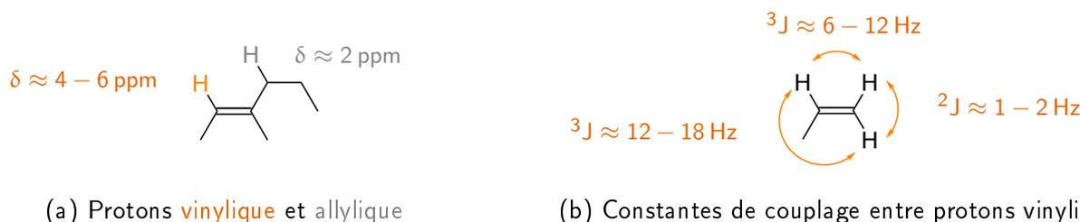
FIGURE 5 – Signatures spectroscopiques en résonance magnétique nucléaire  $^1\text{H}$  des dérivés éthyléniques
