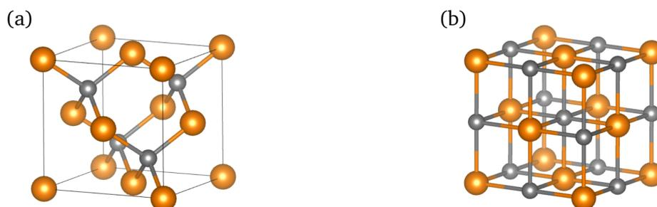
FIGURE 5 – Structures de maille potentielles pour les *quantum dots* de sélénure de cadmium synthétisés. Les ions cadmium  $\text{Cd}^{2+}$  et sélénure  $\text{Se}^{2-}$  sont représentés respectivement en orange et en gris. Pour une structure dont chaque sommet et chaque centre des faces est occupé par un ion cadmium  $\text{Cd}^{2+}$ , les ions sélénure  $\text{Se}^{2-}$  peuvent alors occuper soit la moitié des sites tétraédriques (a), soit la totalité des sites octaédriques.
