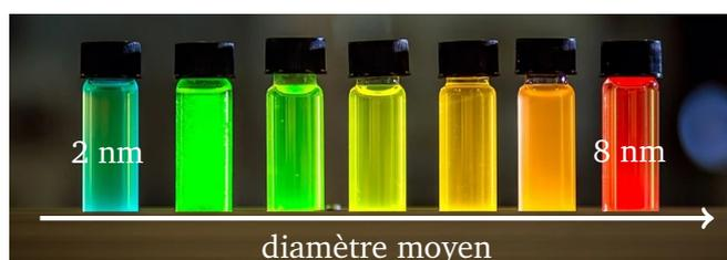
FIGURE 1 – Illustration des propriétés de fluorescence des *quantum dots* de sélénure de cadmium CdSe en fonction du diamètre moyen des nanoparticules. Toutes les nanoparticules ont été excitées par une onde ultraviolette  $\lambda = 365$  nm.
