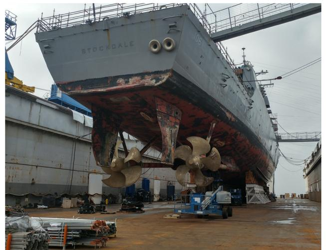
FIGURE 8 – Comparaison entre la peinture anti-rouille de l'USS Shoup (gauche) avant son lancement et la peinture de l'anti-rouille de l'USS Stockdale (droite) lors d'un de ses entretiens en cale sèche. (Deux vaisseaux de la classe Arleigh-Burke) On note la consommation de la peinture anti-rouille par corrosion galvanique.
