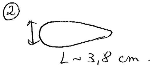
$$C_x = \frac{F}{\frac{1}{2} \rho V^2 \times \pi R^2} \quad \text{en fonction de } Re = \frac{\rho V L}{\eta}$$
