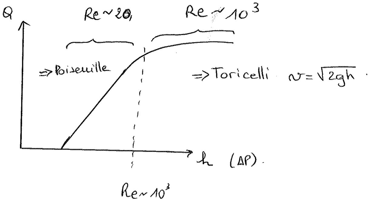
On a mis en évidence 2 régimes d'écoulements et  $Re$  caractérise ces écoulements.
