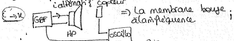
$x \rightarrow i$ : on tape la membrane avec les disques pour l'alimenter  $\Rightarrow$  on voit le signal.
