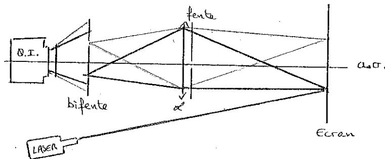
Le laser pointe sur l'image d'une des deux fentes de la bifente. On ferme la fente diffractante : l'image sur l'écran se brouille. On repère le début du brouillage, et on translate alors la fente devant le faisceau laser : la figure de diffraction est telle que le premier minimum se trouve sur l'image de la deuxième fente de la bifente.
