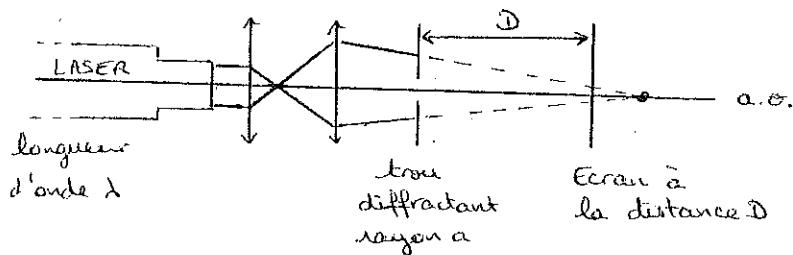
On déplace l'écran le long de l'axe optique afin de passer de la diffraction de Fraunhofer (tache d'Airy) à la diffraction de Fresnel.
