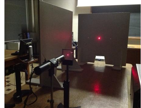
On observe trois points lumineux dans le plan focal d'une lentille mince convergente, ce qui correspond à trois directions dans l'onde diffractée par la mire sinusoïdale selon les vecteurs unitaires :  $\vec{u}_0, \vec{u}_1, \vec{u}_{-1}$ . La tâche centrale d'intensité plus forte est dans le prolongement du faisceau lumineux incident, les deux tâches secondaires d'intensité identiques mais moindres sont symétriques par rapport à la tâche centrale, espacées d'une distance h.
