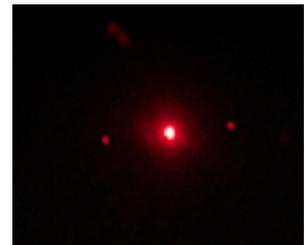
**Expérience de cours** : on éclaire un réseau sinusoïdal avec un laser monochromatique (3 longueurs d'onde différentes), qu'on assimile à une onde plane sous incidence normale.
