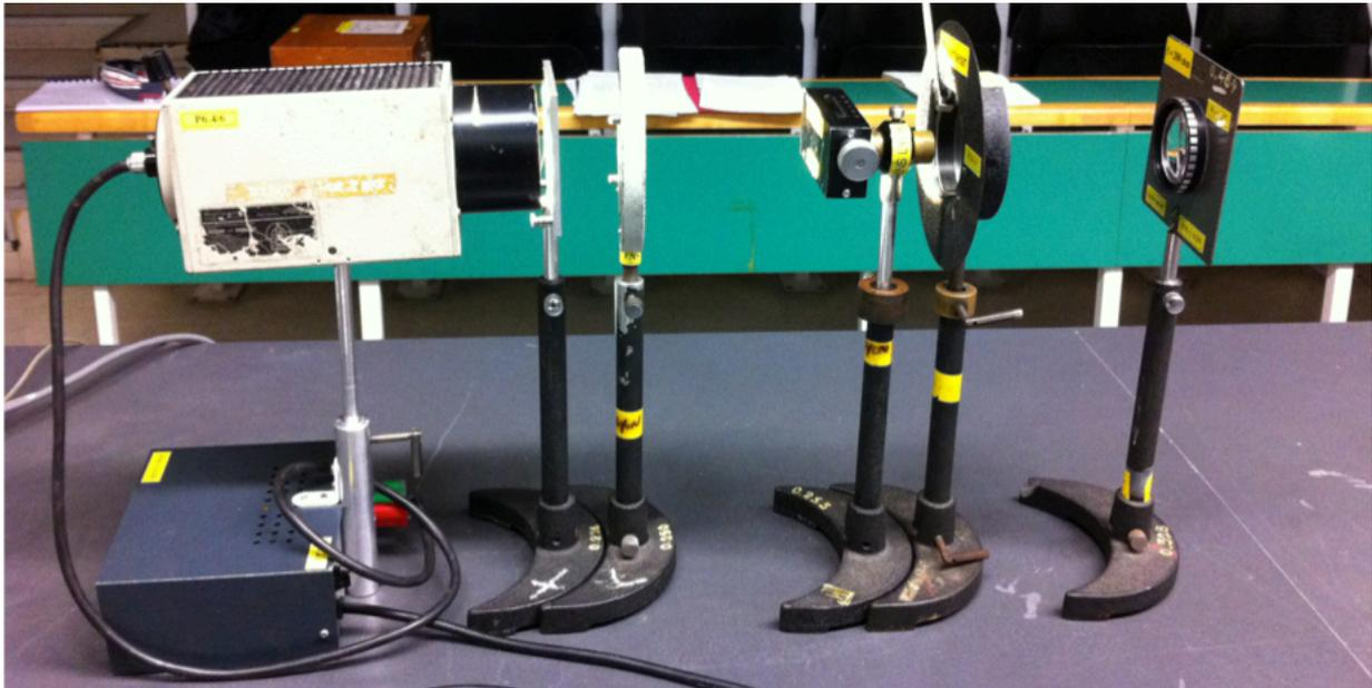
FIGURE 4 – Montage du compensateur de Babinet entre polariseur et analyseur croisés. La lentille ( $f' = 20\text{cm}$ ) est un achromat pour former l'image des réticules sur l'écran.
