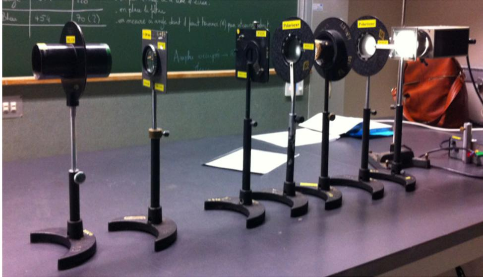
FIGURE 5 – Montage de l'étude de la polarisation rotatoire dans un canon de quartz. De droite à gauche : QI+AC, polariseur, canon de quartz, analyseur, fente, achromat de  $f' = 20cm$ , PVD
