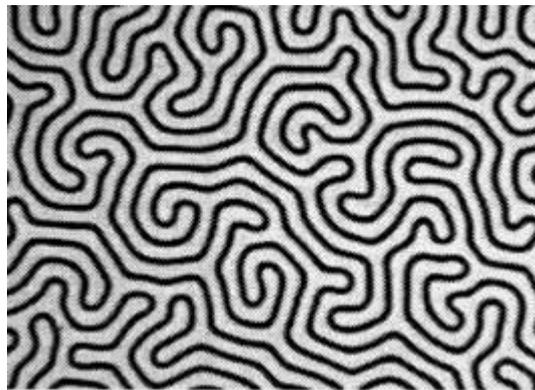
*Domaines magnétiques dans une couche mince de grenat observés au microscope polarisant par effet FARADAY<sup>1</sup>*
