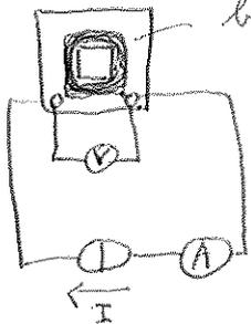
bobine MAF 543 1000 spires  $\phi = 0,8 \text{ mm}$
