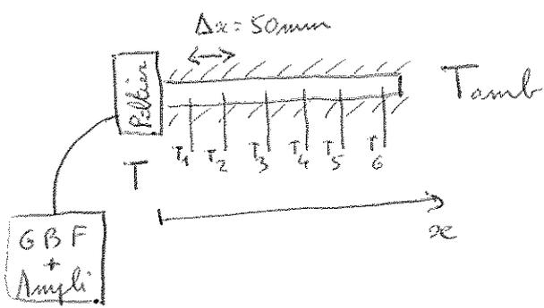
On s'intéresse à la propagation d'ondes de chaleur dans un milieu considéré comme semi-infini. Le module Peltier impose une température en  $x=0$  de la forme
