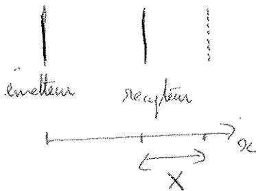
Pour deux positions du récepteur, on relève le temps de vol. Soit  $T$  la différence.
