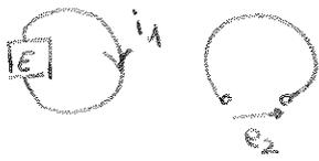
comme on l'a vu, un courant dans la bobine 1 fait apparaître une tension dans la bobine 2.
