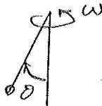
**Manip** : cf. le nouvel engin SVP.... Avec un générateur continu assez puissant, on fait tourner le moteur, et on mesure la vitesse de rotation avec un tachymètre. à l'aide d'un stroboscope, on relève l'angle de la position d'équilibre correspondante. Il existe deux  $\theta$  symétriques, faire donc en sorte d'avoir accès aux deux positions (pour cela, relancer plusieurs fois la rotation.. Statistiquement, chaque position est atteinte une fois sur deux.)
