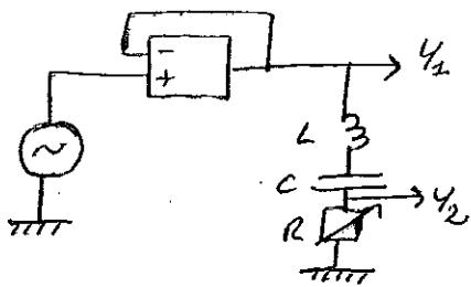
Afin de suivre ou éviter les déformations du signal d'entrée à l'approche de la résonance (permet de faire du GBF un GBF "parfait").
