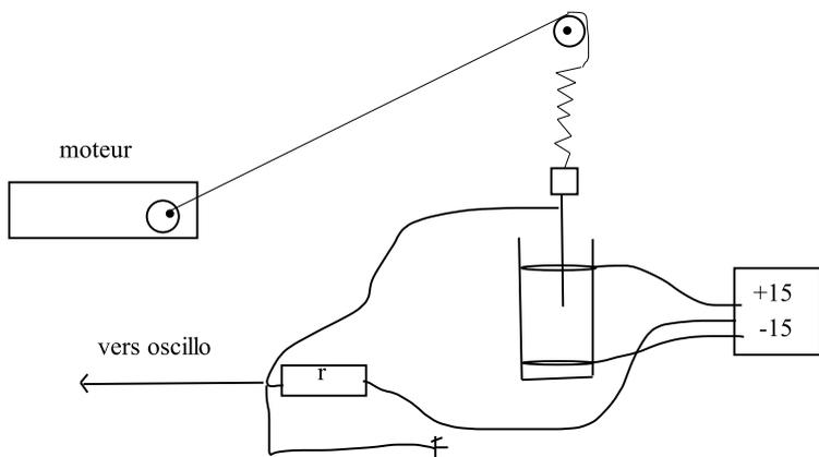
FIGURE 1 – Oscillateur mécanique forcé
