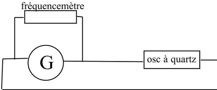
FIGURE 4 – Oscillateur à Quartz
