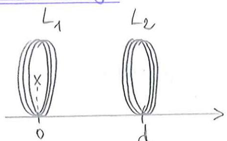
On éloigne les deux bobines d'une distance  $d$  ce qui diminue le couplage induit.
