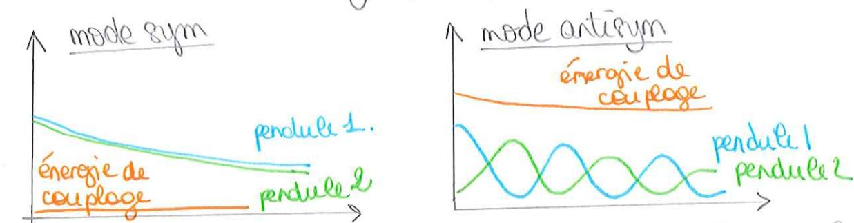
$\Rightarrow$  le couplage entre les deux pendules est maximal pour le mode antisymp et nul pour le mode symétrique.
