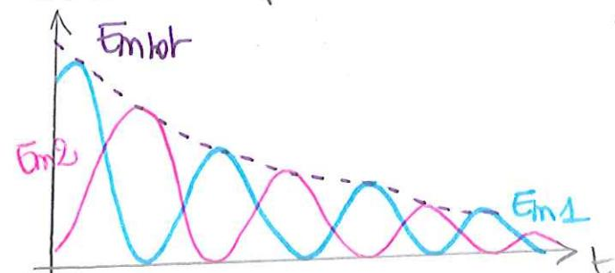
$\Rightarrow$  il y a transfert d'énergie d'un pendule à l'autre au cours du temps
