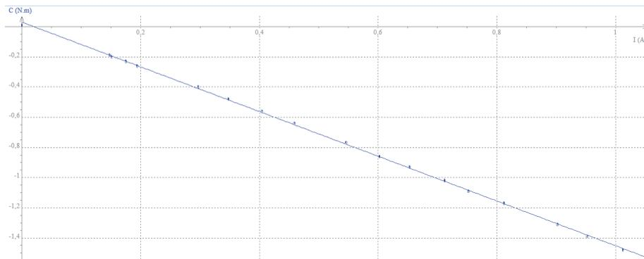
FIGURE 4 – Couple fourni  $C$  (en  $N.m$ ), en fonction du courant Induit  $I$  (en  $A$ ).
