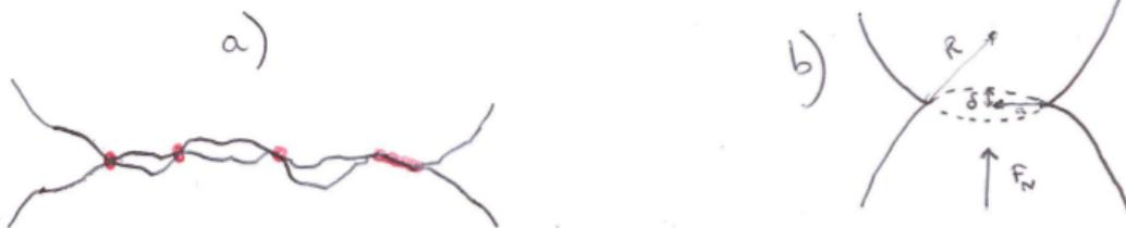
Figure 1: (a) Contact microscopique. (b) Notation pour la loi de Hertz:  $R$  est le rayon de courbure de la rugosité.
