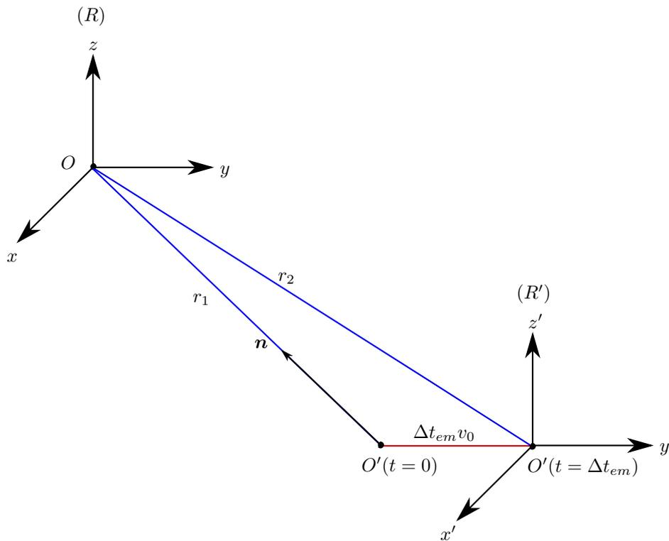
FIGURE 3 – Le récepteur  $O'$  se déplace à la vitesse  $\mathbf{v}_0 = v_0 \mathbf{e}_x$  par rapport à  $O$ . Entre les deux instants  $t = 0$  et  $t = \Delta t_{rec}$ ,  $O'$  parcourt la distance  $\Delta t_{em} v_0$  dans  $(R)$ , comme illustré sur la figure.
