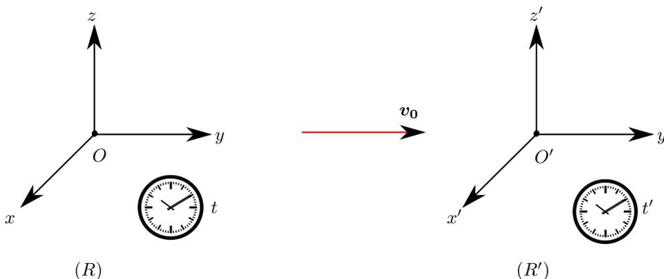
FIGURE 2 – Deux référentiels inertiels sont en translation rectiligne uniforme l'un par rapport à l'autre. On note  $\mathbf{v}_0$  la vitesse de  $O'$  par rapport à  $O$ . Si  $M$  est un événement quelconque, ses coordonnées peuvent être exprimées dans  $(R)$  ou dans  $(R')$ .
