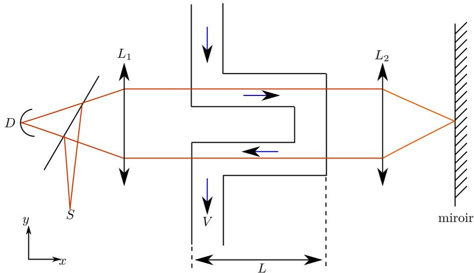
FIGURE 1 – Principe de l'expérience de Fizeau. L'eau circule à la vitesse  $V$  relativement au référentiel du laboratoire. Les faisceaux sont émis par une source  $S$ , séparés par un miroir semi-réfléchissant puis arrivent au détecteur  $D$  après un aller-retour à travers les deux bras du circuit hydraulique.
