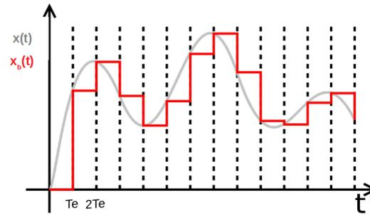
Figure 12 : Échantillonneur bloqueur
