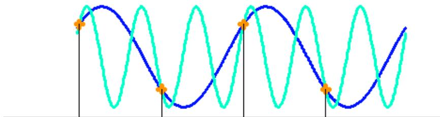
Figure 9 : Signal sous échantillonné.
