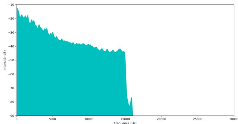
Figure 7 : Spectre du son après démodulation et filtrage.
