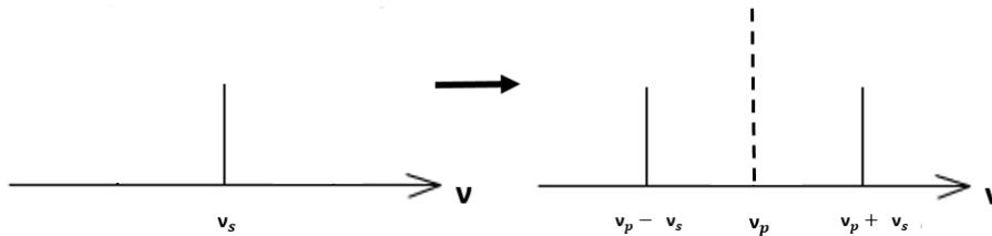
Figure 3 : Spectre d'un signal après modulation..
