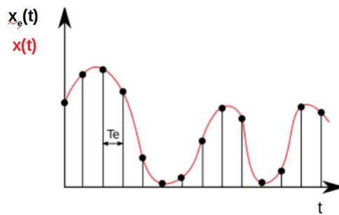
Figure 8 : Signal échantillonné.
