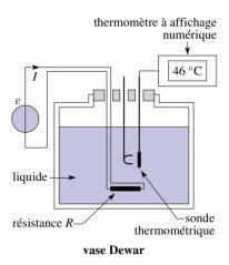
Cette fois, au lieu de mettre en contact deux systèmes avec des températures différentes, nous allons étudier l'échauffement d'un unique corps provoqué par l'apport d'un travail électrique. Pour cela on introduit dans le calorimètre une masse m d'eau puis on plonge dans l'eau une résistance chauffante alimentée par une tension e et un courant i fournis par une alimentation stabilisée. Le travail électrique fourni par le générateur au système pendant une durée  $\Delta t$  est alors :
