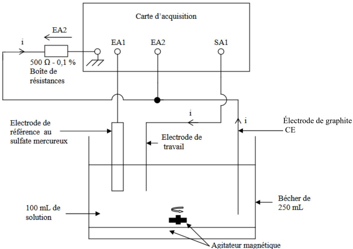
Réaliser le montage en utilisant un porte-électrodes (à 3 électrodes), un bécher de 250 mL, un barreau aimanté et une agitation magnétique.
