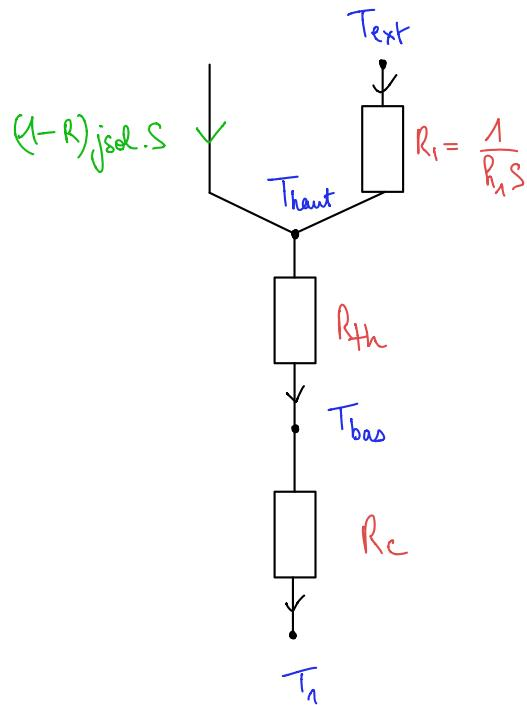
point diviseur de tension à  $T_{bas} - T_h$  :  $T_{bas} - T_h = (T_{haut} - T_h) \frac{R_c}{R_c + R_{th}}$  à déterminer
