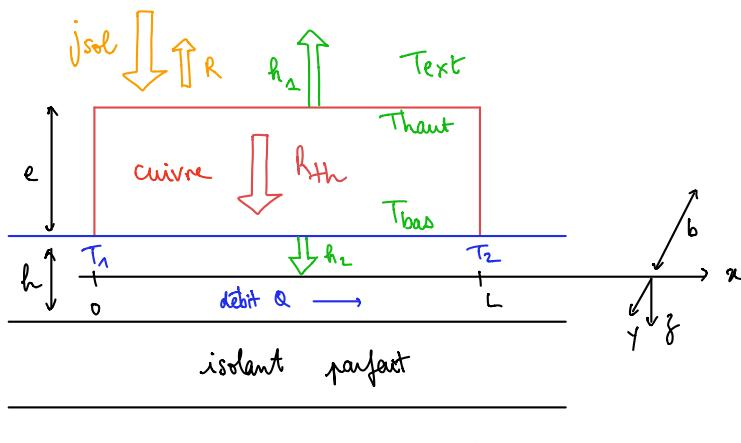
bilan au cuivre (conservation de la puissance transmise)  $(1-R) j_{\text{sol}} \cdot bL + j_{\text{ext} \rightarrow \text{solide}} \cdot bL = (T_{haut} - T_{bas}) / R_{th}$ .  $\Rightarrow P_{\text{solide} \rightarrow \text{fluide}}$
