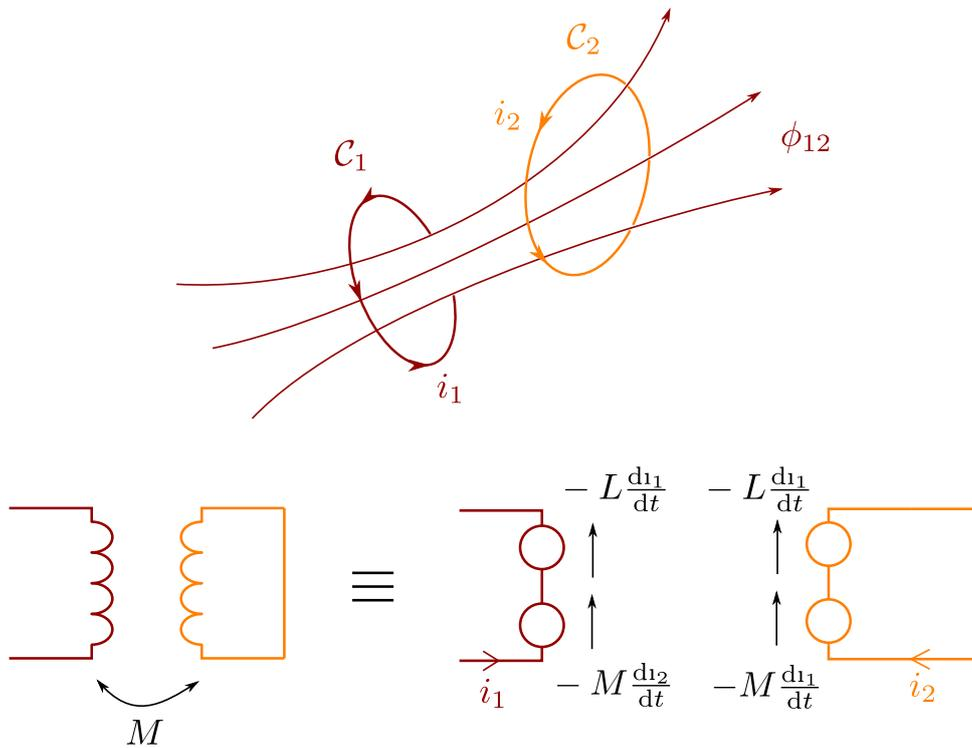
Fig. 1 : Schéma équivalent, évidemment il y a une erreur, un  $i_2$  est devenu un  $i_1$ .
