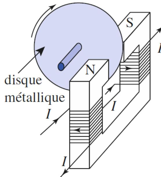
Fig. 4 : Système de freinage par induction
