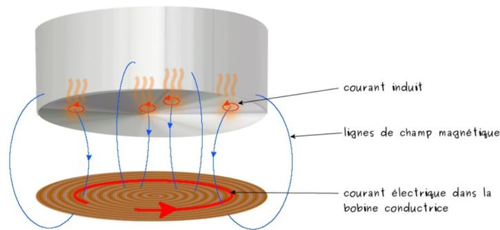
Fig. 3 : Chauffage par induction
