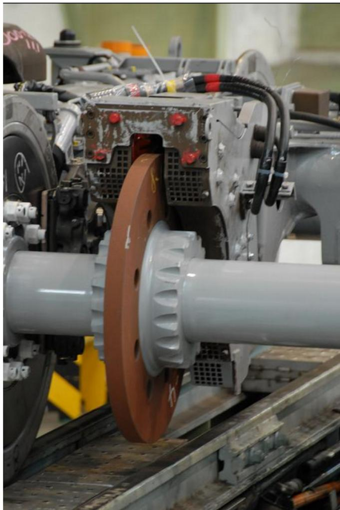
Fig. 5 : Système réel de freinage par induction
