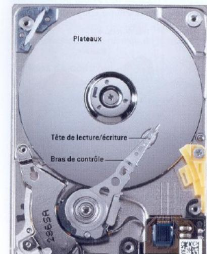
7 Cette photo de l'intérieur d'un disque dur montre les éléments indispensables à son fonctionnement : les plateaux et la tête de lecture/écriture à l'extrémité du bras de contrôle. On aperçoit également une partie de l'électronique du contrôleur qui transmet les données à l'ordinateur.
