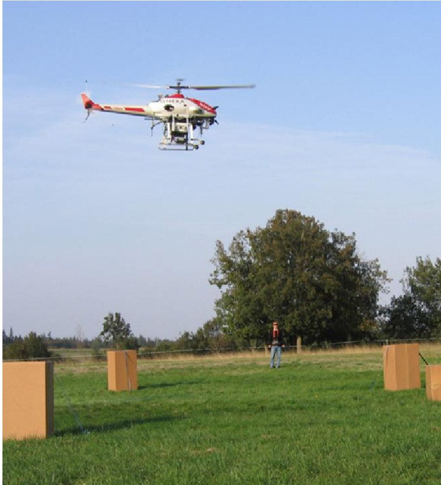
Figure 13.1. Mission de recherche de zones d'atterrissage par un hélicoptère autonome embarquant des algorithmes de décision basés sur les MDP
