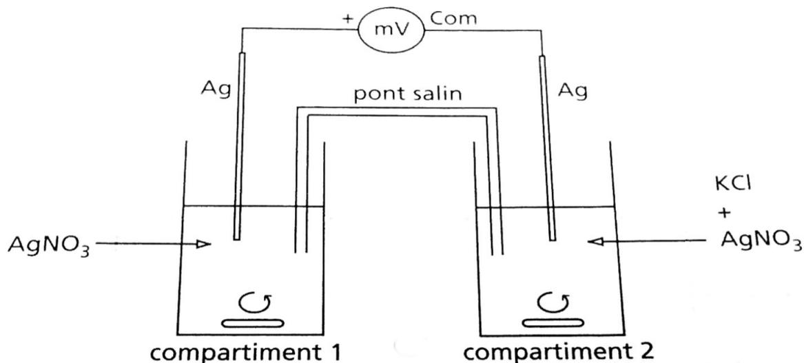
Protocole : on met 50 mL de nitrate d'argent à  $10^{-2}$  mol/L dans le compartiment 1 et on met 50 mL de chlorure de potassium à  $10^{-2}$  mol/L avec quelques gouttes de nitrate d'argent dans le compartiment (on veut voir apparaitre un solide pour être sûr qu'on est saturé). On mesure alors la différence de potentiel entre les deux compartiments.
