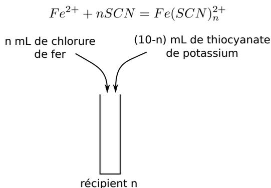
Le principe de la méthode de Job est le suivant : le maximum de la courbe d'absorption correspond à quand on a formé le maximum de complexe et donc quand il y a des réactifs dans des conditions stoechimétriques. Le maximum permet donc d'obtenir la stoechiométrie du complexe. On trouve ici une stoechiométrie 1 :1.
