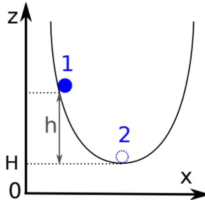
Ce résultat intuitif vient en fait d'un concept bien maîtrisé en mécanique qui est la minimisation de l'énergie potentielle. L'énergie potentielle peut s'écrire ici en fonction des deux paramètres  $H$  et  $h$  :
