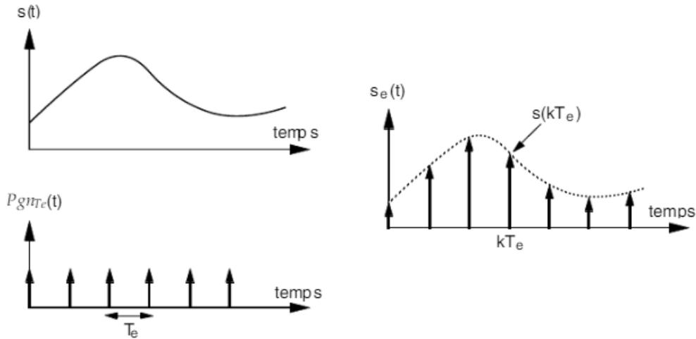
On l'a vu précédemment : réussir à obtenir la transformée de Fourier d'un signal revient à obtenir le signal lui-même. Mais qu'en est-il du signal que l'on vient de générer ? On regarde sa transformée de Fourier : le théorème de Plancherel dit que la transformée de Fourier d'un produit est le produit de convolution des TF (on admet la formule pour le peigne de Dirac) :
