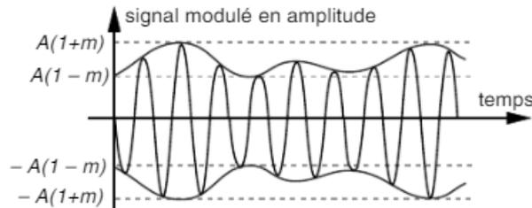
L'information sur  $i$  se trouve alors dans la porteuse : c'est pour ça qu'elle dépend du temps. Spectralement, on a 3 fréquences :
