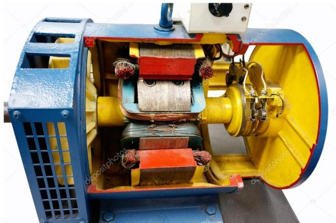
FIGURE 11 – Coupe d'une machine synchrone. On distingue en particulier deux des trois bobines qui créent le champ statorique (coupées), et le rotor alimenté en courant continu par deux bagues sur la droite.
