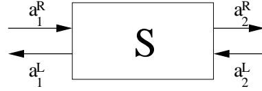
FIG. 3.5: Boite noire décrite par 4 coefficients complexes (matrice S ) qui relie les amplitudes des fonctions d'ondes d'électrons entrants et sortants de la boite.
