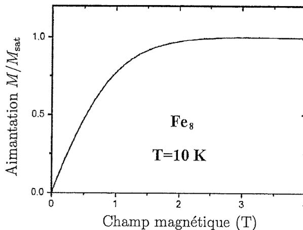
FIG. 10 - Aimantation normalisée en fonction du champ magnétique  $B_z$ .
