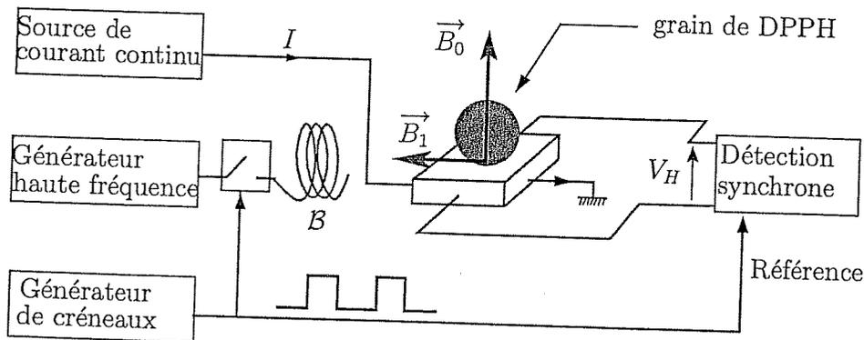
FIG. 5 - Configuration de mesure. Un grain sphérique de DPPH est déposé sur la sonde
