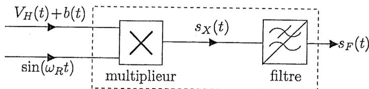
FIG. 7 – Détection synchrone
