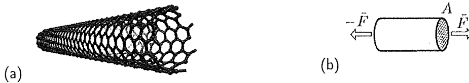
FIGURE 2 – (a) Structure d'un nanotube de carbone. (b) Traction longitudinale sur un cylindre de section A .
