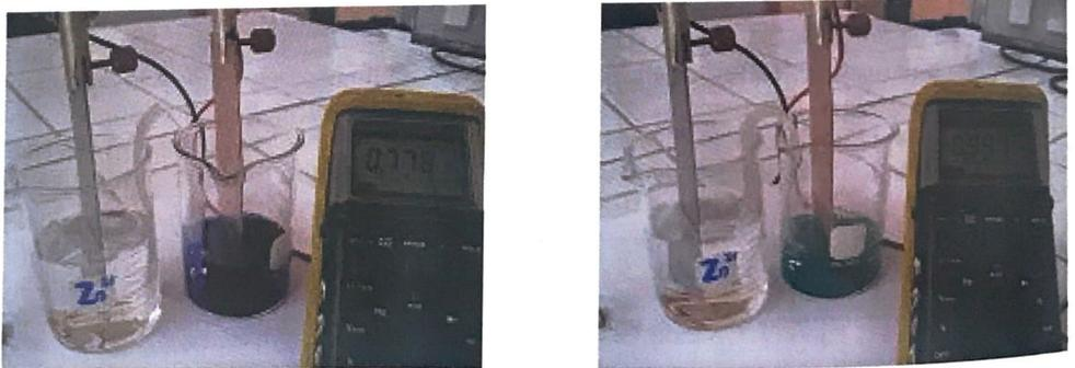
Fig. 3 D.9c : mesure des forces électromotrices après complexation (gauche) et précipitation (droite)
